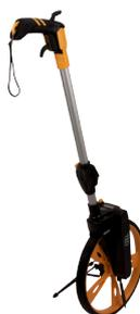
Conception ergonomique et robuste. Il est équipé d'une poignée pistolet facilitant le déclenchement et la réinitialisation du compteur.
